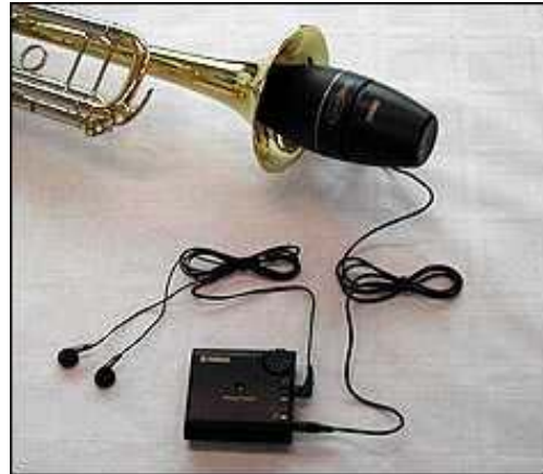
Figur 4 Kombineret dæmper og pick-up system. Foto © med velvillig tilladelse fra Yamaha Music.
