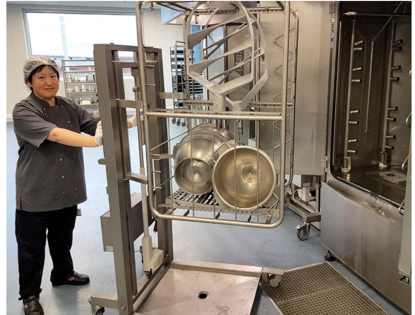
På Det Nye Universitetshospital i Aarhus er opvaskerummet adskilt fra de øvrige rum. Xiao Hong Lu anvender Granul-opvaskemaskinen til grovopvask af de store køkkenting.
