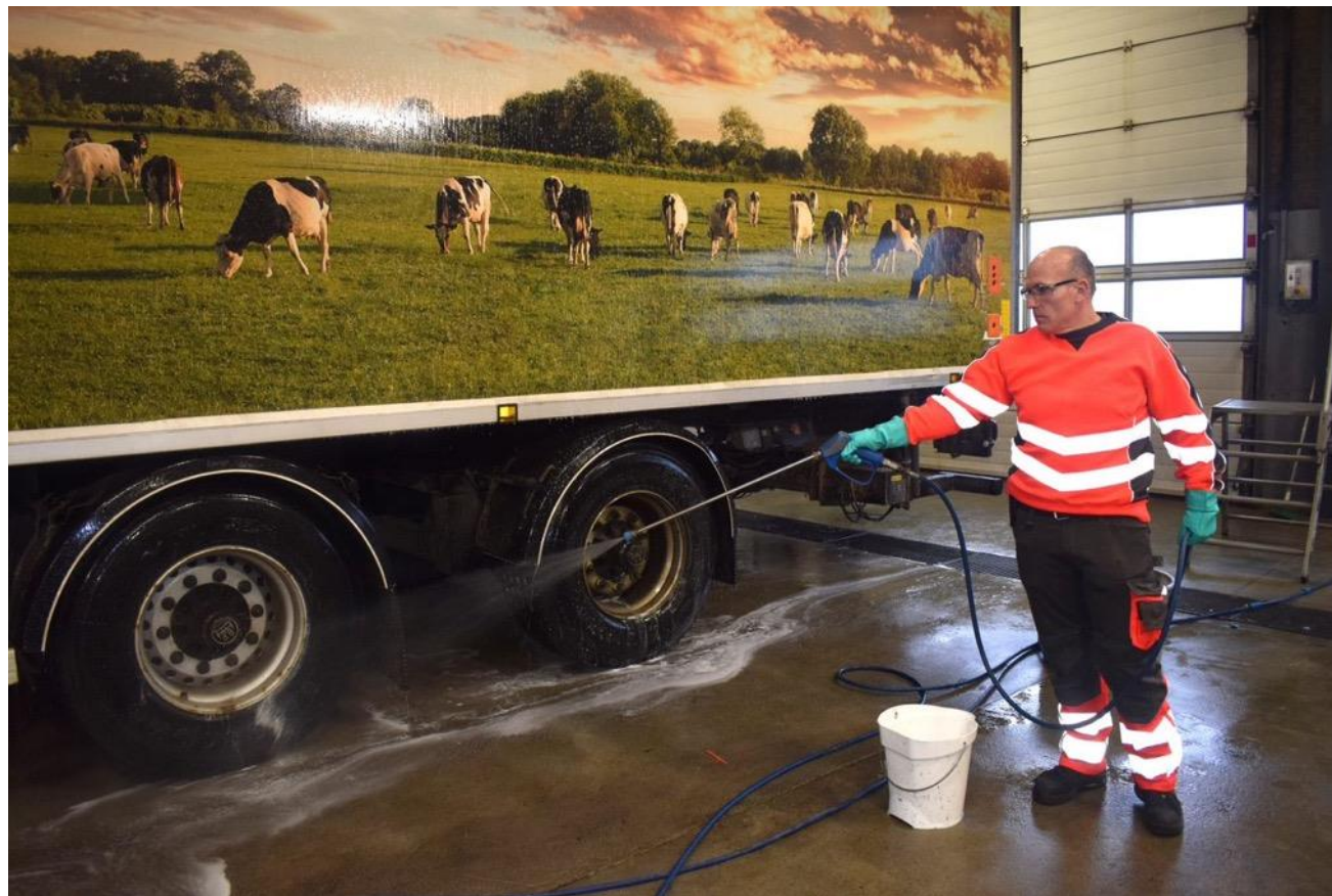
Udvendig skumudlægning af distributionsbil
