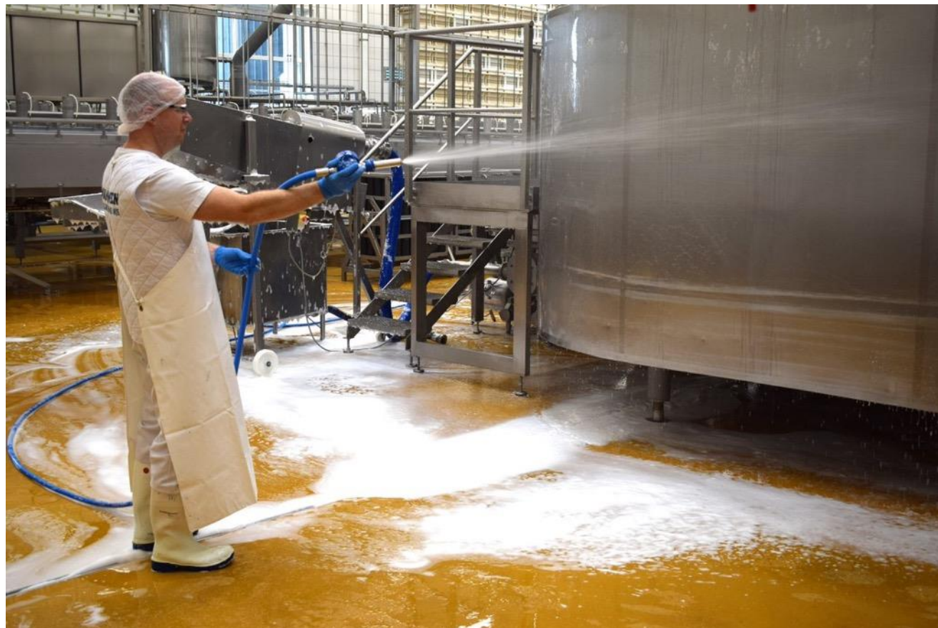
Skumudlægning på tankanlæg
