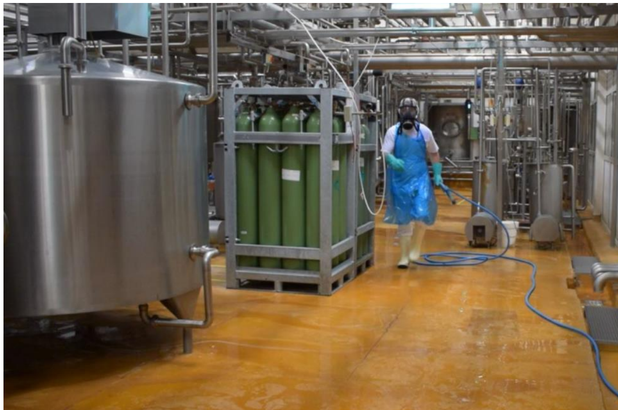
Afskylning med vand efter skumudlægning
