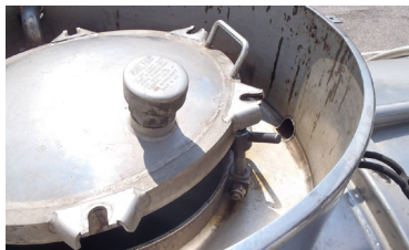
Et åbent domedæksel sidestilles med et hul i siden på tanken.
