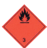
Fareseddel nr. 3 Brandfarlig væske
