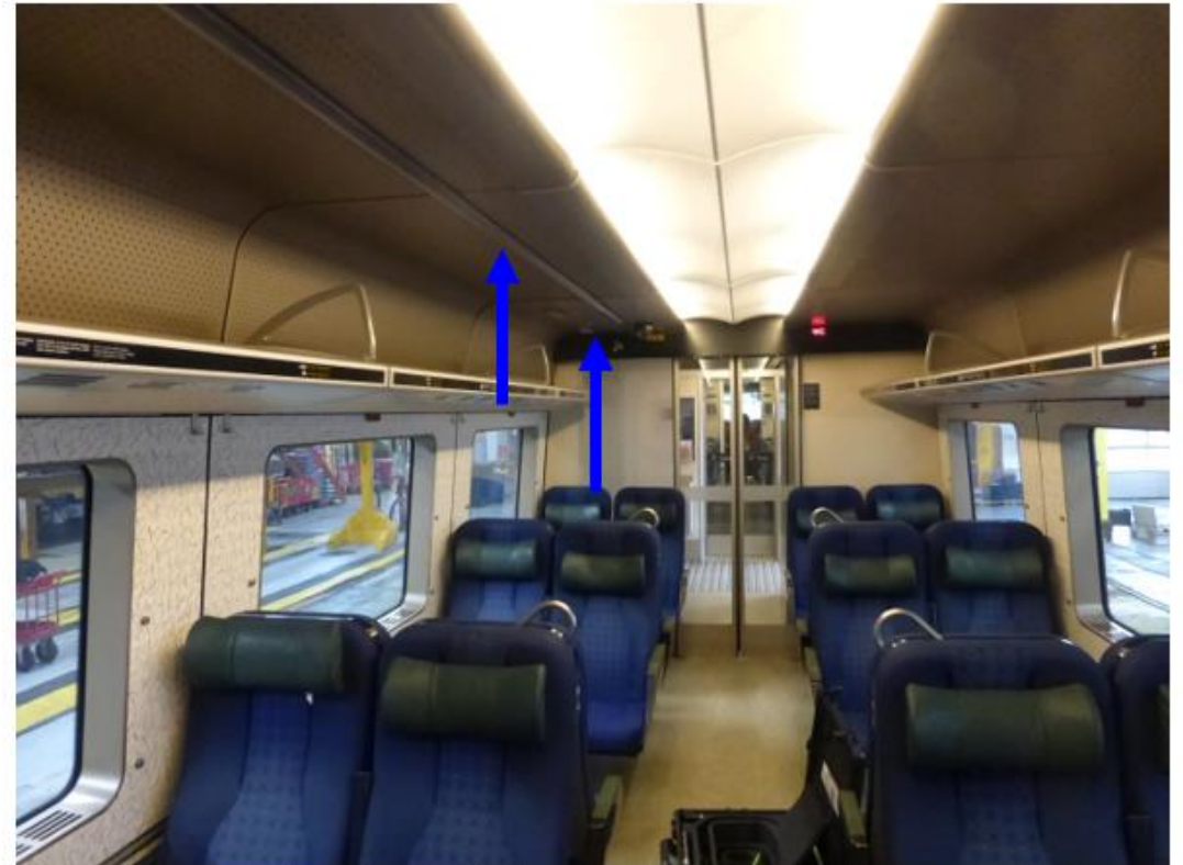
Målepunkt 8 og 9 – nr. 8 ved leak feeder til mobildækning og nr. 9 ved antenner for WiFi.
