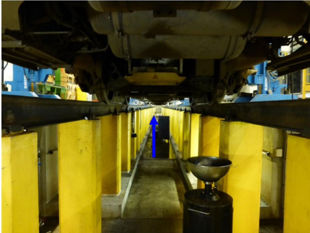
Målepunkt 1 i Hårlev - Graven nedenfor balise antennen i den ene ende af toget - måling foretaget ca. 30 cm lige under antennen
